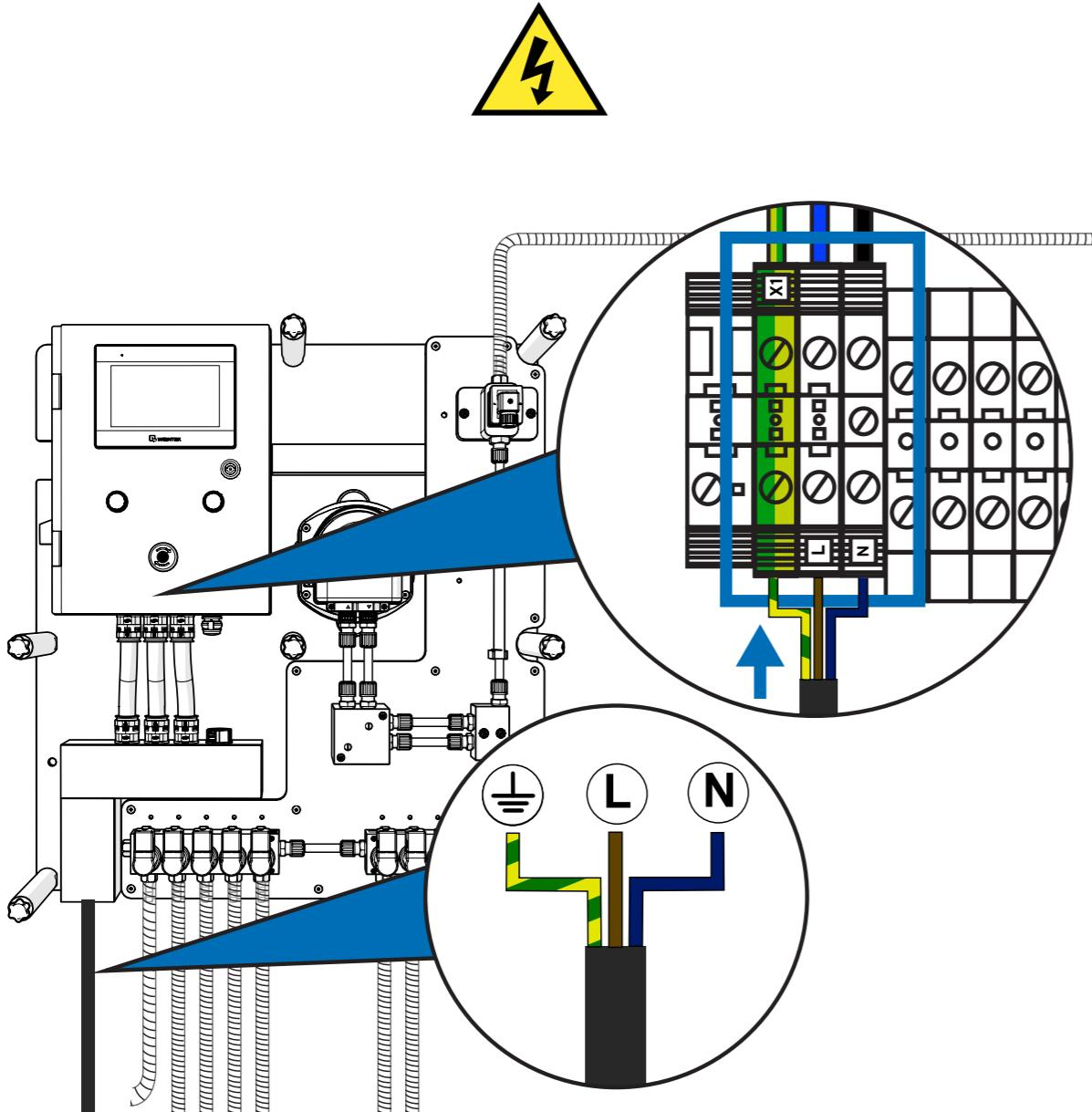
Pro napájení zařízení je nutné použít kabel 3x1.5mm<sup>2</sup>. Kabel prostrčte kanálem umístěným vlevo dole a pomocí jedné z kabelových vývodek jej bezpečně zasuňte dovnitř rozváděče. Připojte ke svorkám označeným X1, které se nacházejí vlevo dole na přípojkách.
