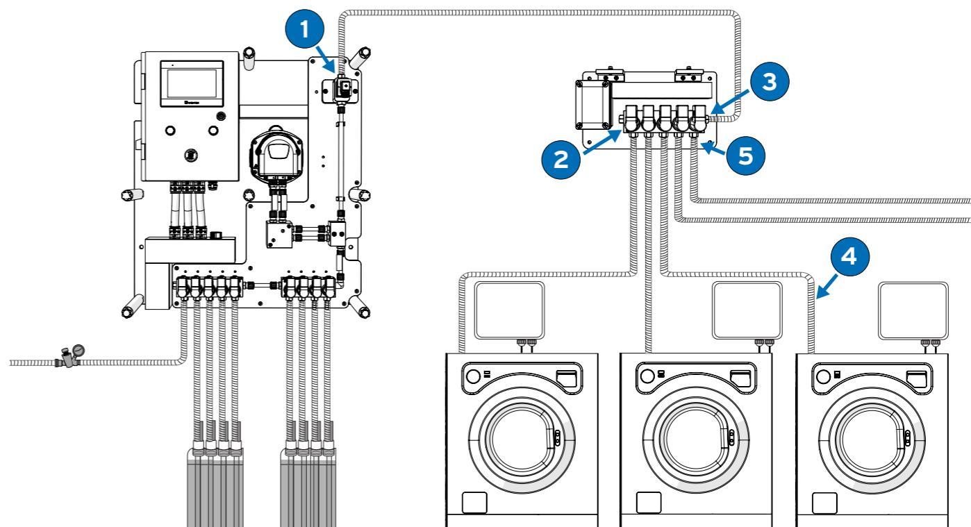
K připojení zařízení, rozdělovače a podložek použijte PVC trubku 10x16 ok a svorky z nerezové oceli.
