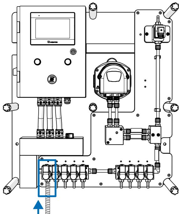
Připojte přívod vody ke krajnímu levému elektromagnetickému ventilu na středovém panelu jednotky.
