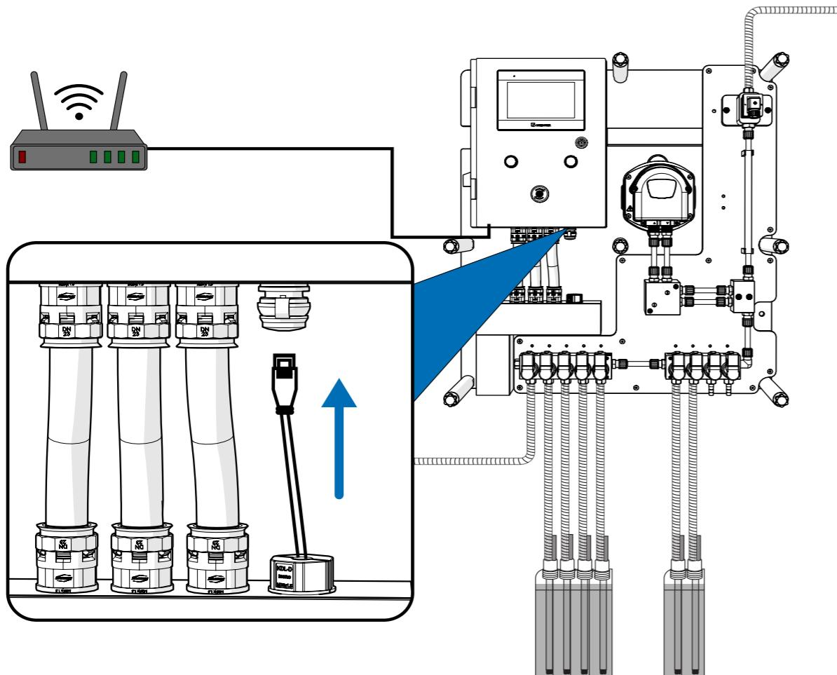
Chcete-li jednotku připojit k internetu, jednoduše připojte ethernetový kabel k libovolnému směrovači přes konektor umístěný na spodní straně hlavní skřínky.
