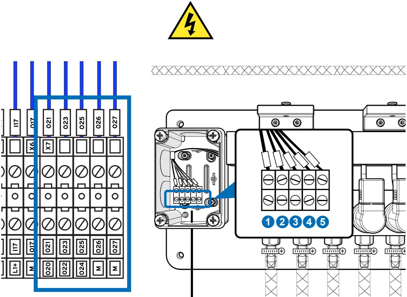
Pro spojení mezi řídicí kabinou a rozdělovačem použijte kabel 7x1mm<sup>2</sup>. Připojte rozdělovač ke svorkovnici X7. Každé připojení svorek odpovídá zásuvkám očíslovaným zleva doprava, přičemž jejich počet závisí na pořadí. Níže je uvedeno schéma zapojení hlavní jednotky.
