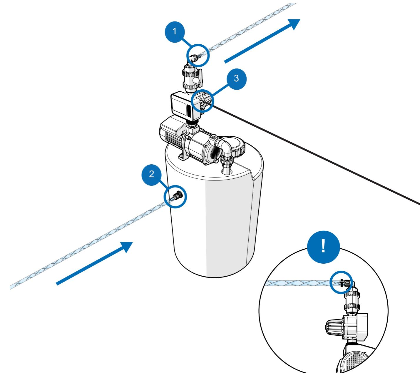
Vezměte prosím na vědomí, že jednotka vyžaduje průtok min. 2/l za minutu - max. 10/l za minutu a dynamický tlak v rozmezí 1,5 bar (min) - až 3 bar (max). Pokud není k dispozici stálý přívod, doporučuje se použít posilovací nádrž.
