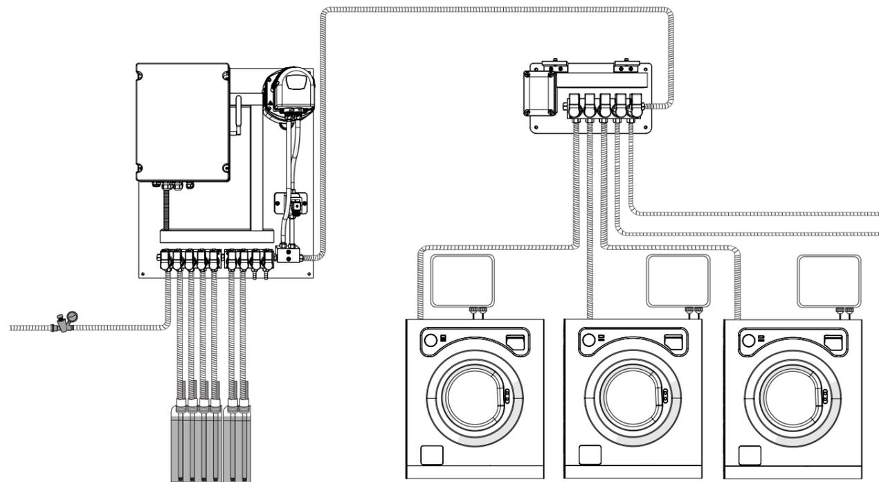
Dieses Bild zeigt den 'Standard' Aufbau einer Multiplex-Einheit mit einem Kanal, wobei "Kanal" als eine Gruppe von Produkten verstanden wird, die in denselben Verteiler eingespritzt und zu einem Verteiler (Waschmaschinen) oder einer Einspritzung (Tunnel) geleitet werden.
