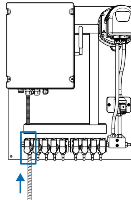
Schließen Sie die Wasserversorgung an das Magnetventil ganz links auf der mittleren Platte des Geräts an.
