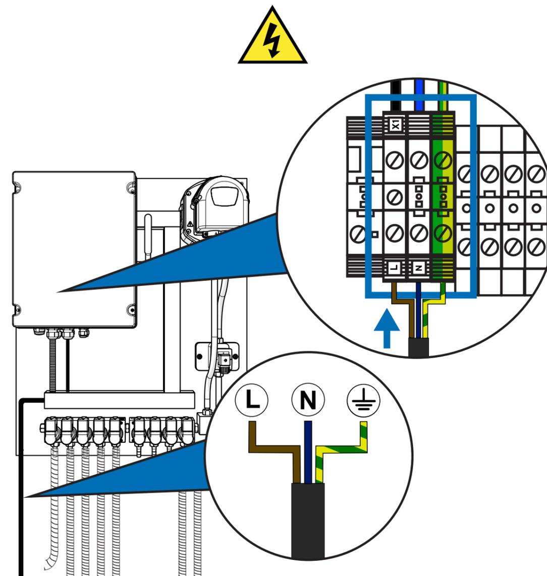
Für die Stromversorgung des Geräts müssen Sie ein 3x1'5mm<sup>2</sup> Kabel verwenden. Führen Sie das Kabel durch den Kanal unten links und verwenden Sie eine der Kabelverschraubungen, um es sicher in den Schaltschrank einzuführen. Schließen Sie es an die mit X1 gekennzeichneten Klemmen an, die sich links unten an den Anschlüssen befinden. Die Stromversorgung muss in geeigneter Weise geschützt sein. Verwenden Sie eine spezielle Leitung für die Stromversorgung des Geräts.
