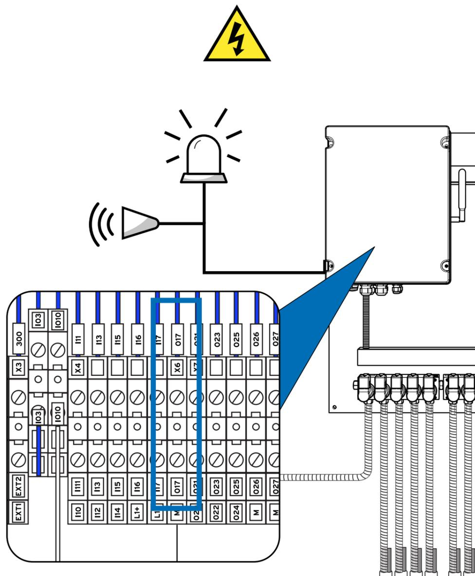
Um einen externen Alarm oder eine Warnleuchte an das System anzuschließen, verwenden Sie den Steckplatz X6 wie oben dargestellt.
