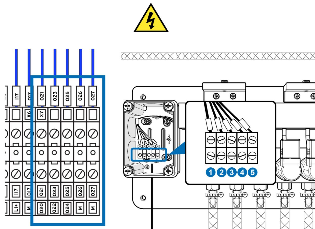
Verwenden Sie ein  $7 \times 1 \text{mm}^2$  Kabel für die Verbindung zwischen der Steuerkabine und dem Verteiler. Schließen Sie den Verteiler an die Klemmleiste X7 an. Jeder Klemmenanschluss entspricht den von links nach rechts nummerierten Ausgängen, wobei die Anzahl von der Reihenfolge abhängig ist. Nachstehend finden Sie den Schaltplan für das Hauptgerät.
