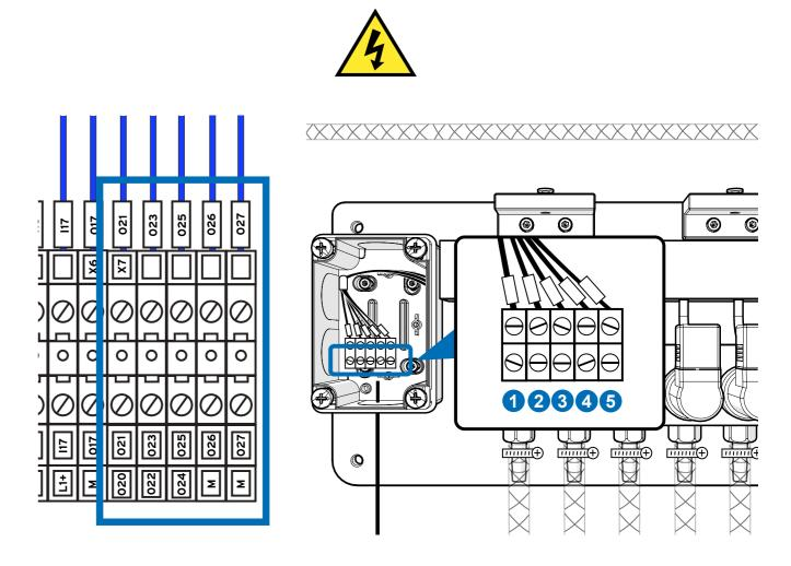
Utilizzare un cavo **7x1mm^2** per il collegamento tra la cabina di comando e il distributore. Collegare il distributore alla morsettiera **X7**. Ogni morsettiera corrisponde alle uscite numerate da sinistra a destra, il cui numero dipende dall'ordine. Di seguito è riportato lo schema di cablaggio dell'unità principale.
