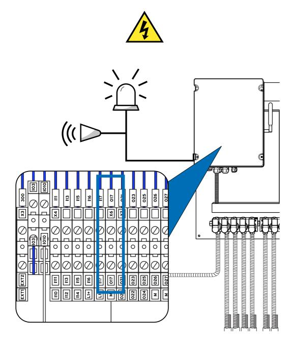
Per collegare al sistema una luce di allarme o di segnalazione esterna, utilizzare lo slot X6 come illustrato sopra.
