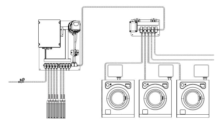
Questa immagine riproduce la configurazione "Standard" di un'unità Multiplex con un canale, intendendo per "Canale" un gruppo di prodotti che vengono iniettati nello stesso collettore e diretti a un distributore (lavatrici) o a un'iniezione (tunnel).
