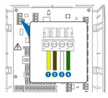
Per collegare la scatola di comunicazione esterna all'unità, collegare il terminale X2 della macchina principale al terminale X1 della scatola di comunicazione. Ogni box di comunicazione può servire fino a due lavatrici.
