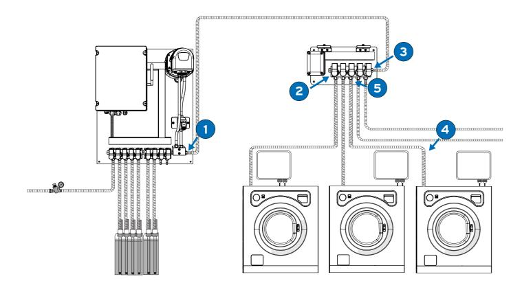
Per collegare le apparecchiature, il distributore e le rondelle, utilizzare un tubo in PVC con maglia 10x16 e morsetti in acciaio inox.
