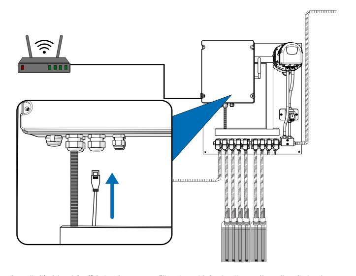
Per collegare l'unità a Internet, è sufficiente collegare un cavo Ethernet a qualsiasi router attraverso il connettore situato sul fondo della scatola principale.
