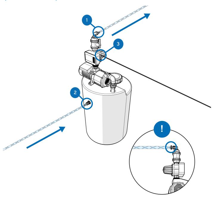
Si noti che l'unità richiede una portata di min. 2/I al minuto - max. 10/I al minuto e una pressione dinamica compresa tra 1,5 bar (min) e 3 bar (max). Si consiglia di utilizzare un serbatoio ausiliario quando non è disponibile un'alimentazione costante.
