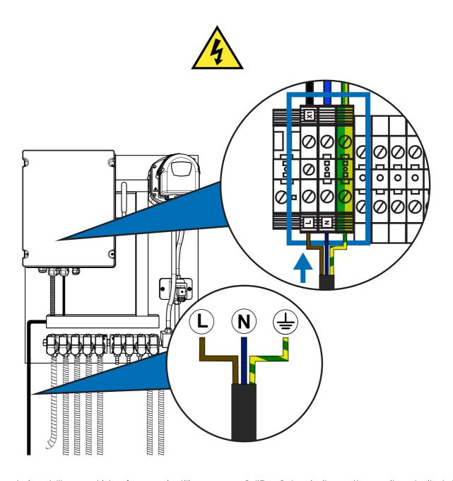
Per l'alimentazione dell'apparecchiatura è necessario utilizzare un cavo **3x1'5mm2** . Inserire il cavo attraverso il canale situato in basso a sinistra e utilizzare uno dei pressacavi per inserirlo in modo sicuro all'interno dell'armadio elettrico. Collegare ai morsetti identificati con **X1** che si trovano in basso a sinistra delle connessioni.
