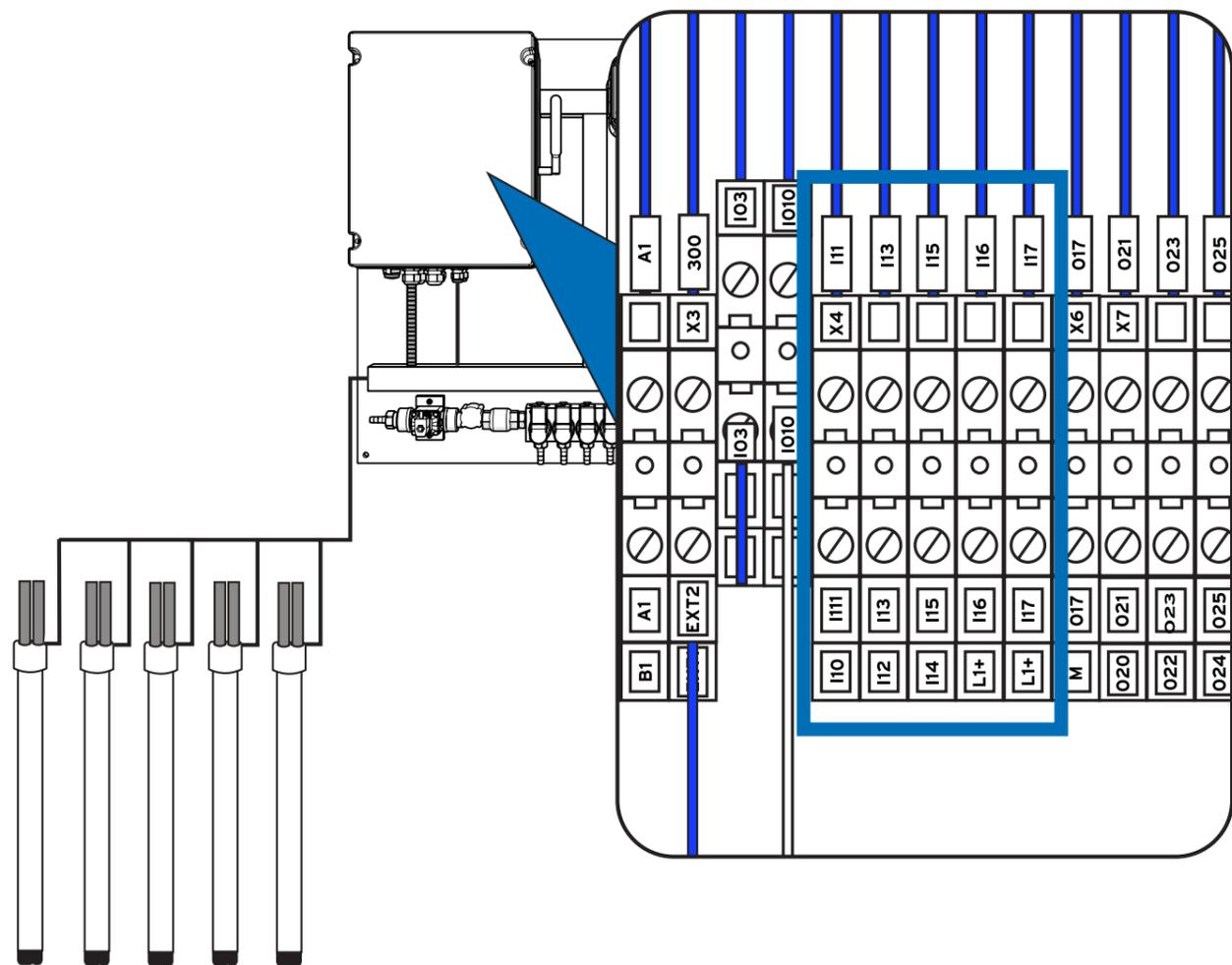
Para conectar las barras de aspiración externas a la máquina, utilice las entradas I10 a I17, como se ha indicado anteriormente.
