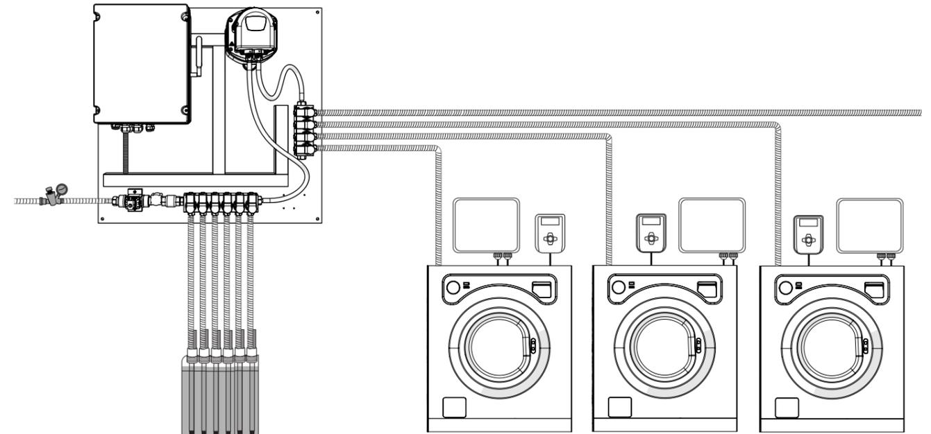
Esta imagen reproduce la configuración "Estándar" de un equipo Multiplex con un canal, entendiendo por "Canal" un grupo de productos que se inyectan en el mismo colector y se dirigen a un distribuidor (lavadoras) o a una inyección (túnel).
