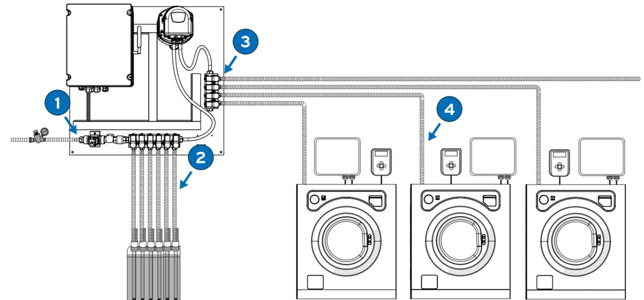
Para conectar el equipo, el distribuidor y las arandelas, utilice tubo de PVC reforzado 10x16 y abrazaderas de acero inoxidable.
