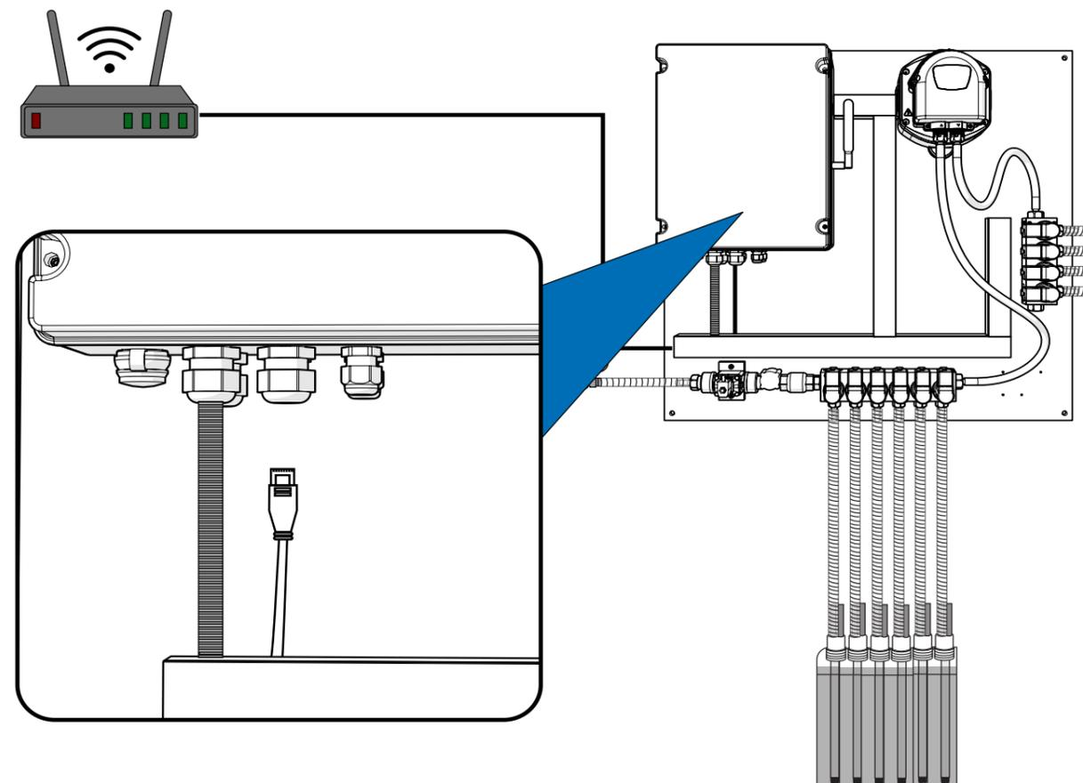
Para conectar el Equipo a Internet, basta con enchufar un cable Ethernet a cualquier router a través del conector situado en la parte inferior de la caja principal.
