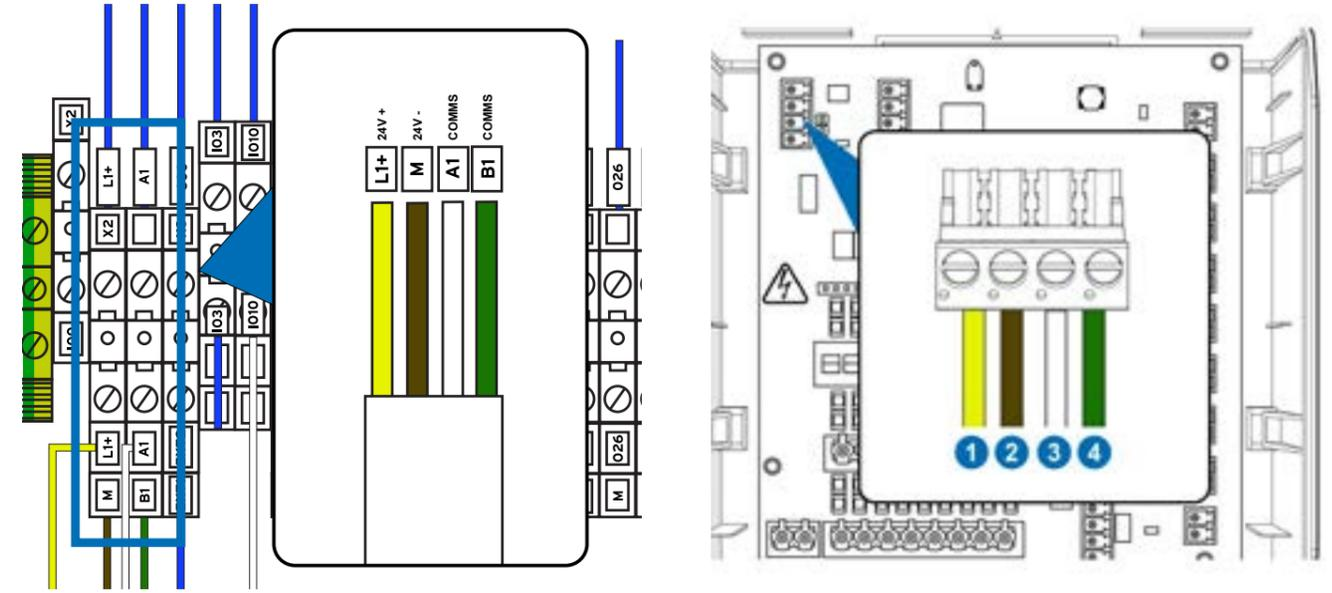
Para conectar la caja de comunicación externa a el equipo, conecte el terminal X2 de la máquina principal al terminal X1 de la caja de comunicación.
