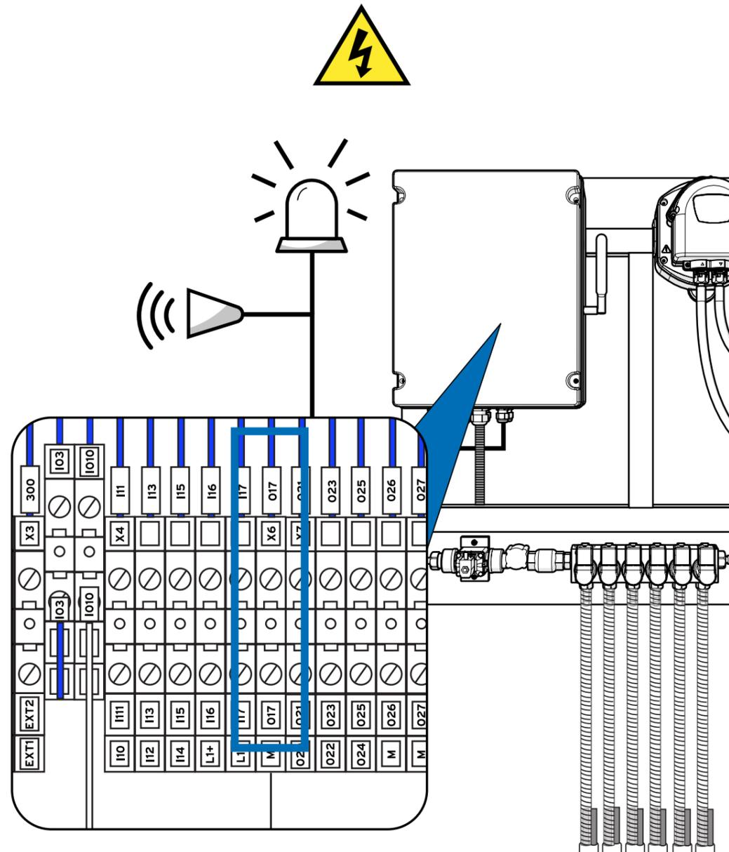
Para conectar una alarma externa o una luz de advertencia al sistema, utilice la ranura X6 como se muestra arriba.
