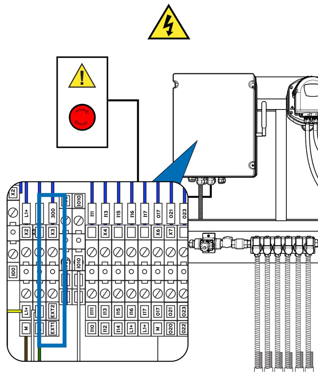
Para conectar un botón de parada de emergencia a su Equipo, puede utilizar la ranura para conectores EXT1 y EXT2 que se muestra arriba.
