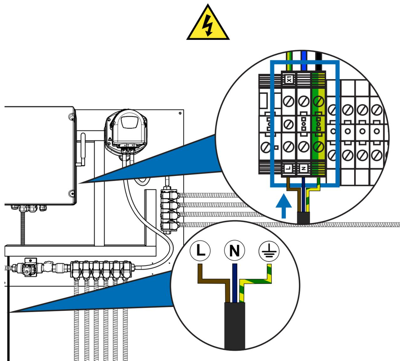
Para la alimentación del equipo debe utilizar **cable de 3x1'5mm<sup>2</sup>**. Introduzca el cable por el canal situado en la parte inferior izquierda y utilice uno de los prensaestopas para introducirlo de forma segura en el interior del armario eléctrico. Conéctelo a los bornes identificados con **X1** que se encuentran en la parte inferior izquierda de las conexiones.
